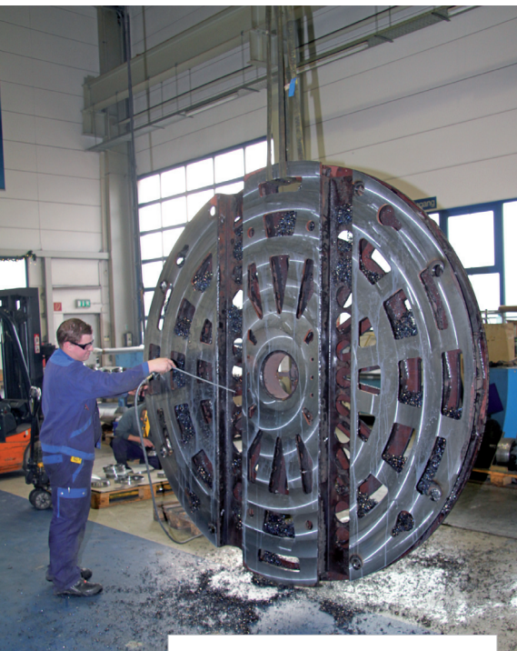
Die vorgegebenen Qualitätswerte hat der WSX445 beim Planfräsen der Schweißkonstruktion schnell und problemlos umgesetzt.
