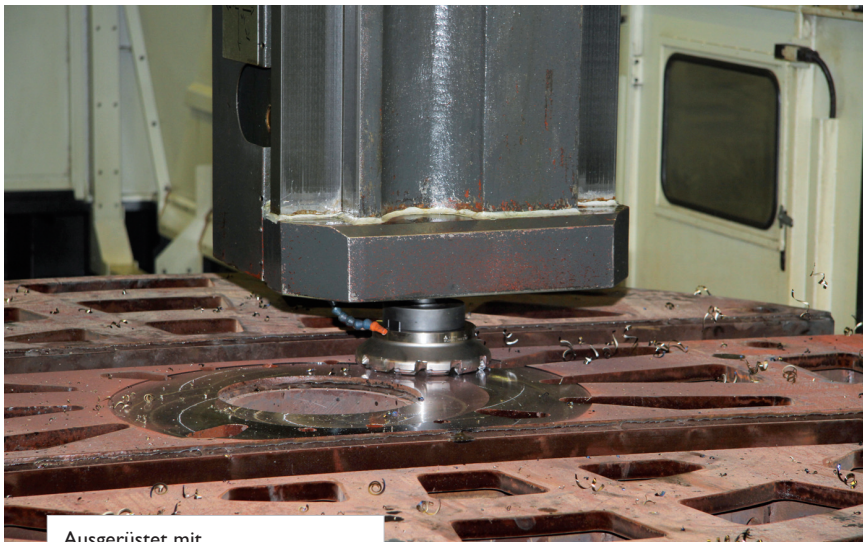
Ausgerüstet mit Wendeschneidplatten in Doppel-Z-Geometrie, die um 26° positiv angestellt sind, hat der WSX445 einen geringen Schnittwiderstand.
