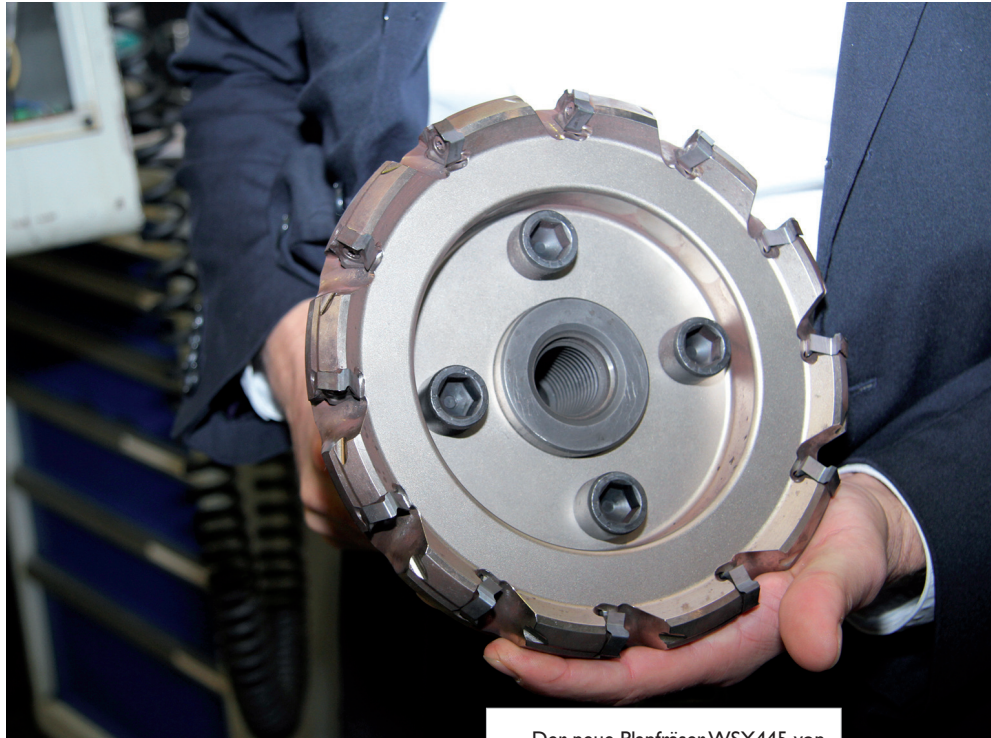
Der neue Planfräser WSX445 von Mitsubishi wird inzwischen auf allen Fräsmaschinen von Baum eingesetzt.
