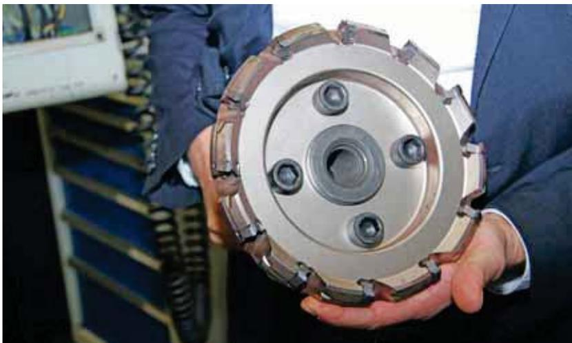
Der neue Planfräser WSX445 von Mitsubishi wird inzwischen auf allen Fräsmaschinen von Baum eingesetzt.
