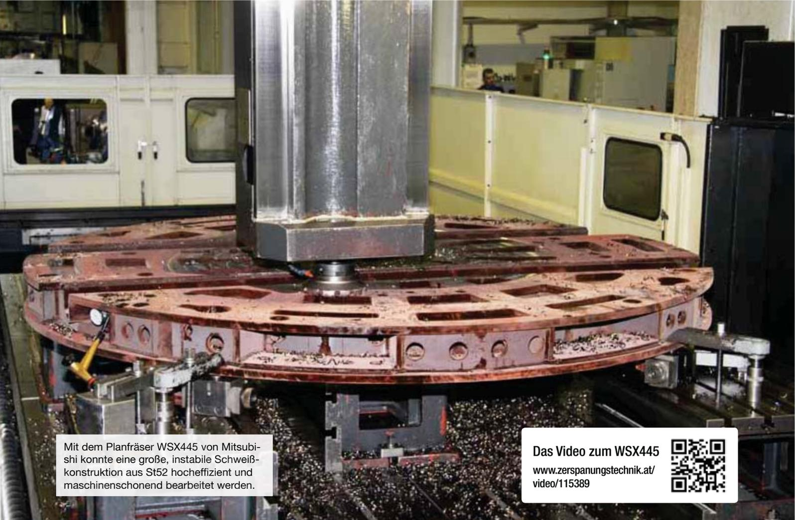
Mit dem Planfräser WSX445 von Mitsubishi konnte eine große, instabile Schweißkonstruktion aus St52 hocheffizient und maschinenschonend bearbeitet werden.
