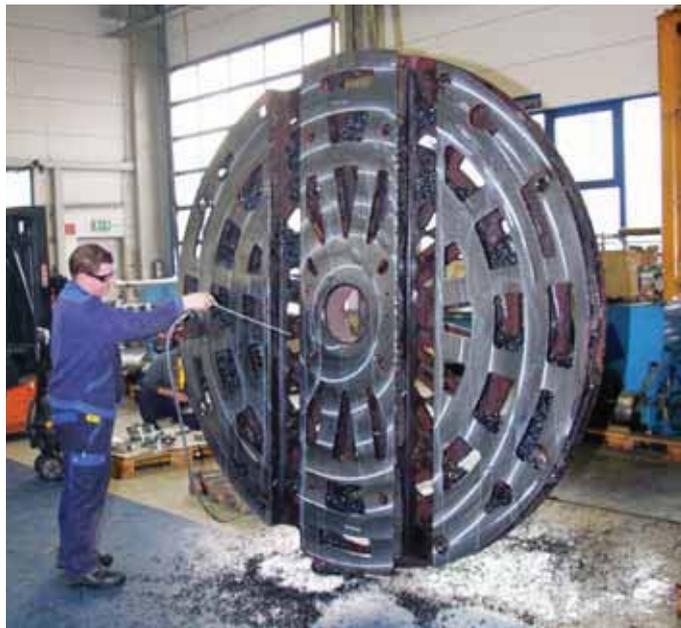
Die vorgegebenen Qualitätswerte hat der WSX445 beim Planfräsen der Schweißkonstruktion schnell und problemlos umgesetzt.
