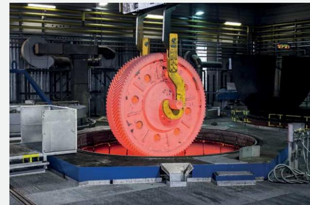
**Bild 3:** Das 21 t-Zahnrad aus den USA verweilt zur Anreicherung der Randschicht mit Kohlenstoff über sechs Tage lang im Ofen
