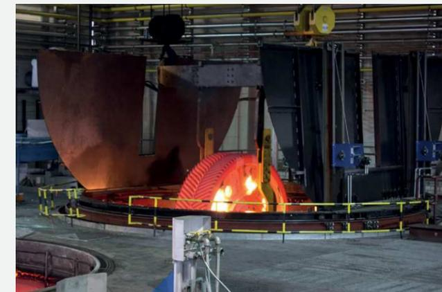
**Bild 4:** Im Abschreckbecken mit 320 000 Liter Spezial-Härtöl erhält die angereicherte Randschicht ihre endgültige Härte
