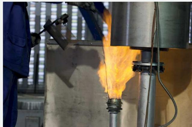
**Bild 2:** Während des Aufkohlens werden Materialproben in den Ofen verbracht, um die Atmosphäre zu kontrollieren
