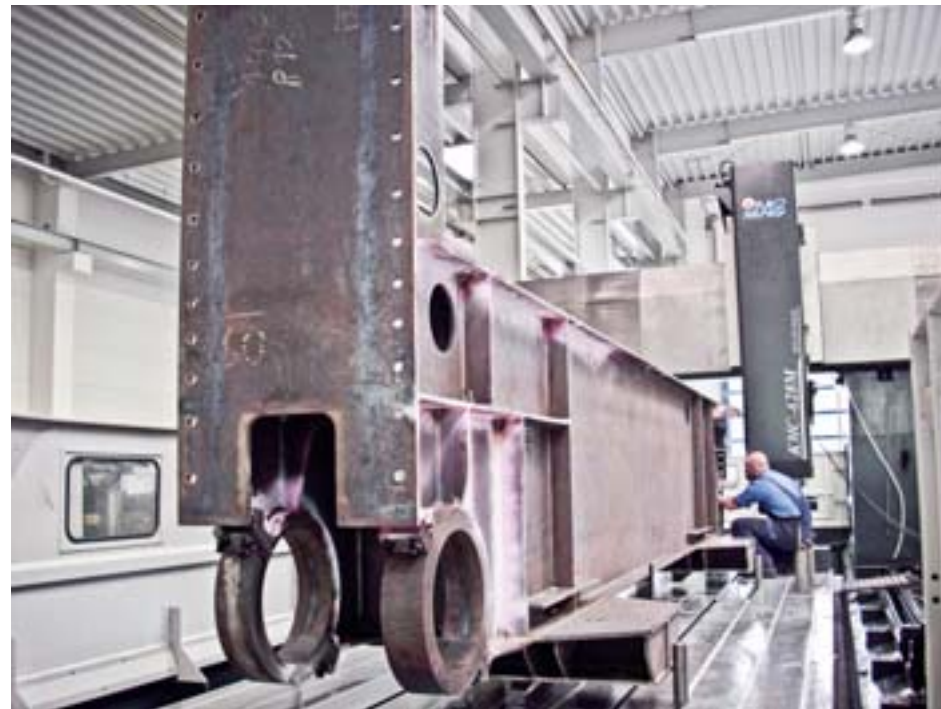
Die Rüstzeiten an der Pilotanlage – einer großen Portalfräsmaschine – sanken von 135 auf 35 min
